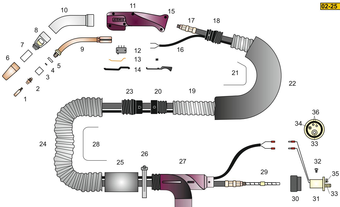
TORCHE ASPIRANTE 34 - Lg : 4.5 m - Deux tronçons- Tube contact M8
