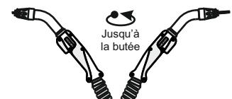
Tournez la poignée dans le sens des aiguilles d'une montre jusqu'à la butée afin que la gaine sorte du col de cygne de 15 mm
